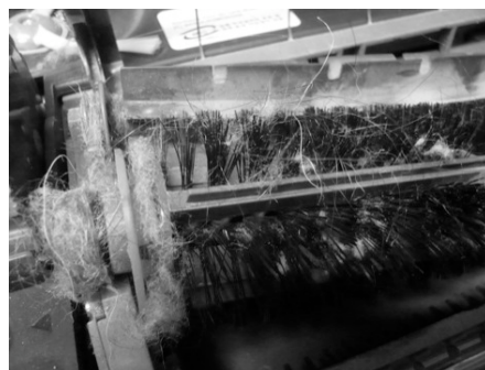
Typisch nach 3 Tagen Putzdienst: Staubreste und Haare setzen sich an den Rädern und Achsen fest.
