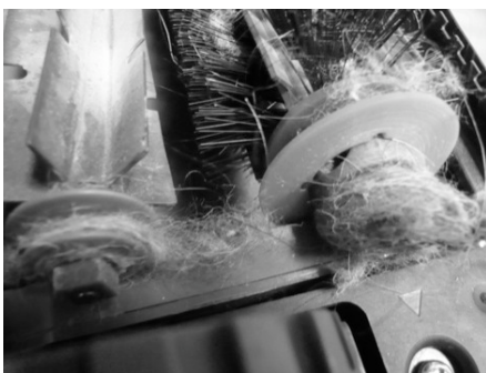
Typisch nach 3 Tagen Putzdienst: Staubreste und Haare setzen sich an den Rädern und Achsen fest.
